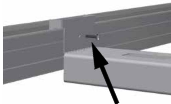
Screw max  $\varnothing$  4.2 mm
